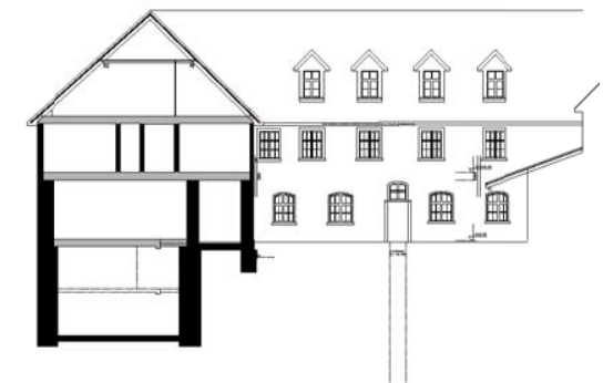
Schnitt durch den Kreuzgarten mit wiederentdeckter Zisterne
